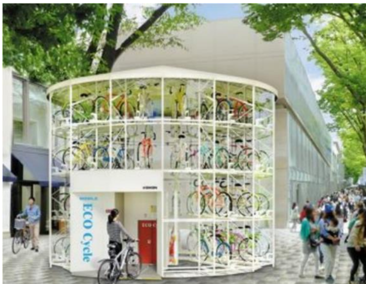
Figură 6-10 Ilustrație parcare publică automatizată de biciclete (Sursa: Ginken)
